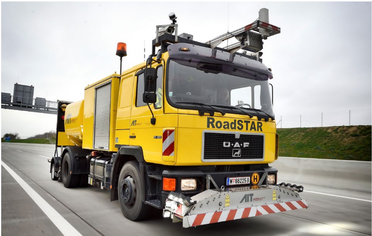
Der RoadSTAR erfasst bei 60 km/h Griffigkeit, Spurrillen und Oberflächenzustand in einem Durchgang – ohne den Verkehr zu beeinträchtigen. © AIT / Johannes Zinner
