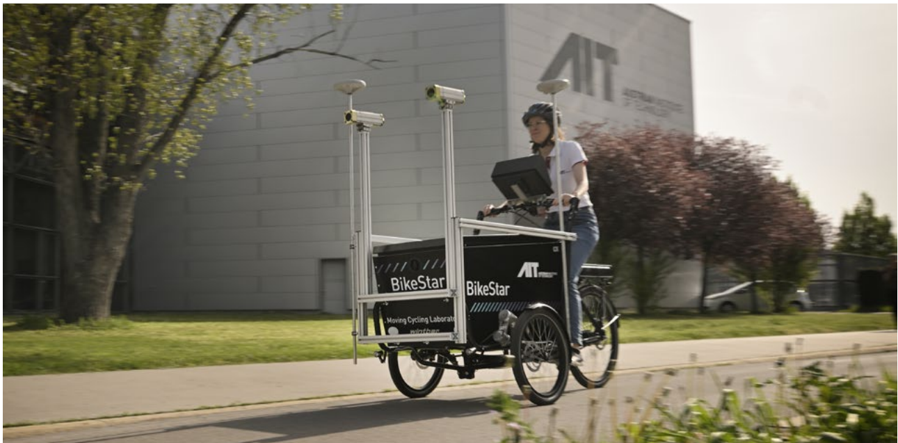
Der BikeStar – rollendes Messlabor für Radinfrastruktur.
