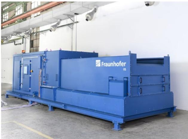
Das Fraunhofer IIS durchleuchtet Abfallströme von einem Prototyp-Sortiersystem mit Hilfe von künstlicher Intelligenz und Röntgentechnologie, um kritische Batterien rechtzeitig zu separieren. Quelle: Fraunhofer IIS / P. Pulkert
