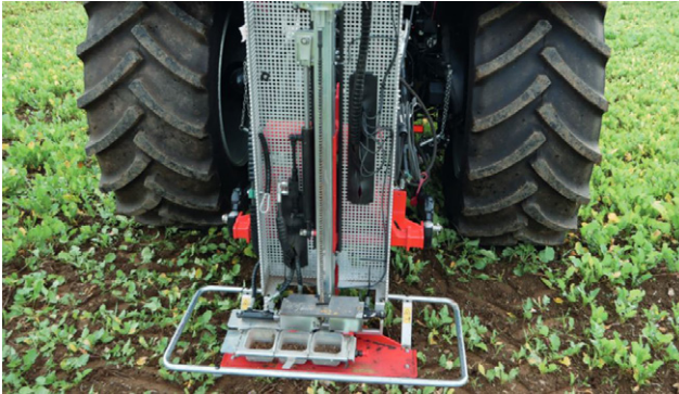
Das Bodenprobenentnahmeggerät ISARIA SCOUT. Quelle: Fritzmeier Umwelttechnik GmbH & Co. KG
