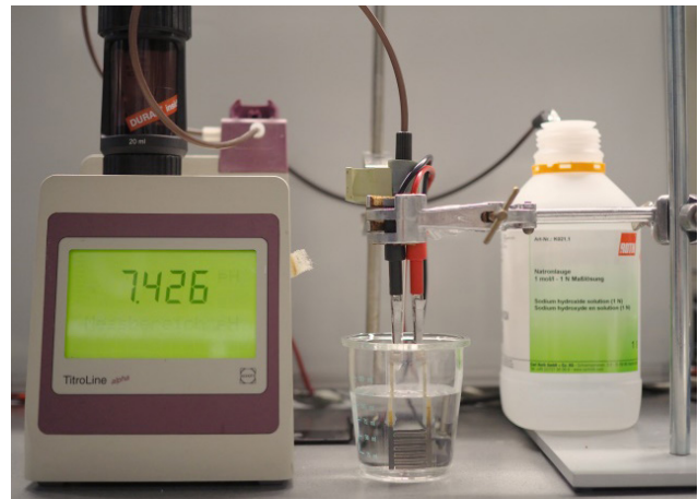
Praktischer Test eines neuartigen Interdigital-pH-Sensors bei einer Säure-Base-Titration. Quelle: OTH Amberg-Weiden
