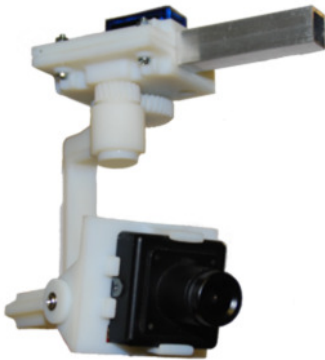
Das SappZ entwickelte einen Quadrocopter für den Einsatz v.a. im Katastrophenschutz . Der Miniatur-Kameraschwenkarm mit Zahnradübersetzung wurde gedruckt. (Foto: SappZ)
