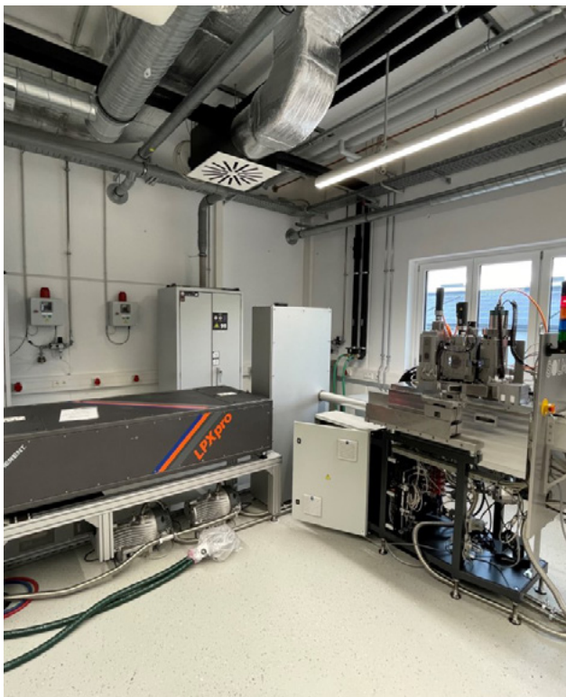
Neuartige PLD-Anlage der Firma Solmates am Technologie Campus Teisnach Sensorik. Quelle: TH Deggendorf
