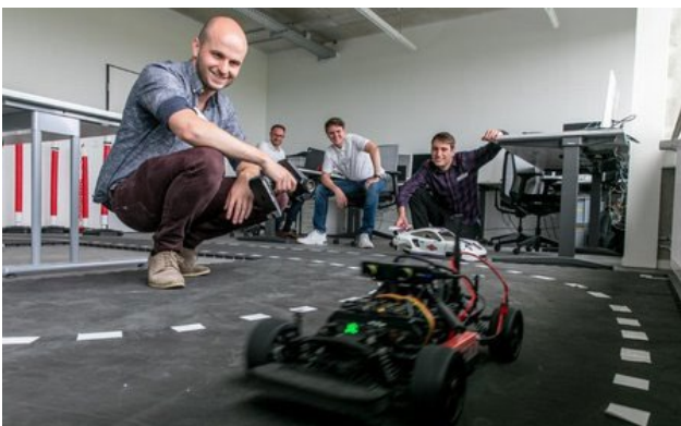
Wissenschaftliche Mitarbeiter und Studierende des AI & Data Science Teams evaluieren Algorithmen des vollautomatisierten Fahrens an Modellfahrzeugen (Foto: Hochschule Kempten).
