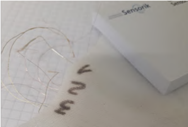
Textil mit integrierten Leitern (entwickelt und aufgebaut von TITV Greiz). Quelle: SBG
