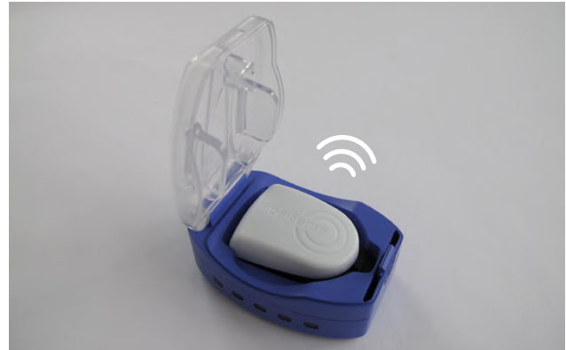
Dieses FiberSense-System für die kontinuierliche Blutzuckermessung wird mit einem Pflaster am Bauch oder Oberarm fixiert. Die digitalisierten Sensorsignale werden drahtlos an das Smartphone oder ein anderes Lesegerät übertragen. Quelle: eesy-ic
