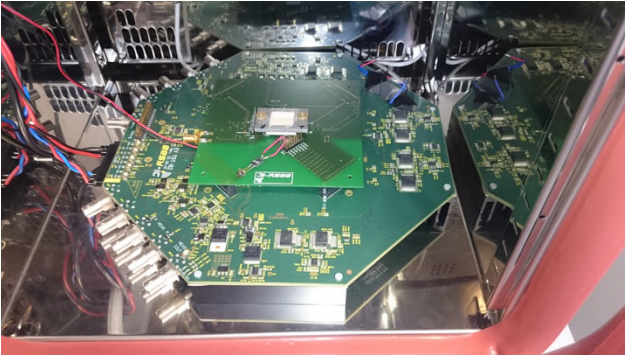
Der für EyeSense entwickelte ASIC (unter der weißen Fixierung) wurde bei eesy-ic umfassend charakterisiert. Quelle: eesy-ic
